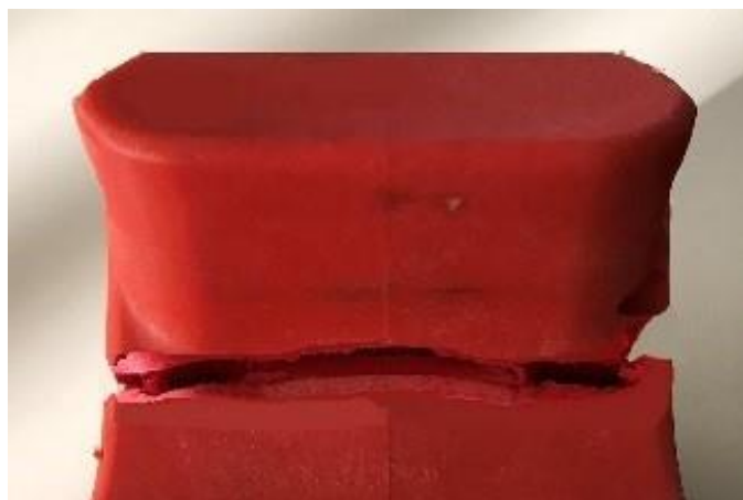
29.78 螺栓位置破裂
